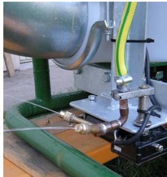
Die Gebläsespritze kann bei Bedarf um einen Zusatz erweitert werden, um den Hornmist ohne Gebläse mittels einer schwenkenden Strahldüse grobtropfig auszubringen. Dies kann bei Bedarf auch in
