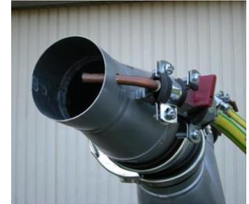
Auf ein ausreichendes Filtern des Präparates sollte man nicht verzichten. Die Spritze ist daher serienmäßig mit einem großvolumigen **Edelstahlsieb** ausgerüstet.
