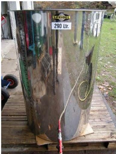
Rührfass ohne nach innen gebogenem Rand, 290 L Volumen; mit Auslass 8 cm über Boden, inkl. Kugelhahn und GeKa-Kupplung (außer kleines Fass).
