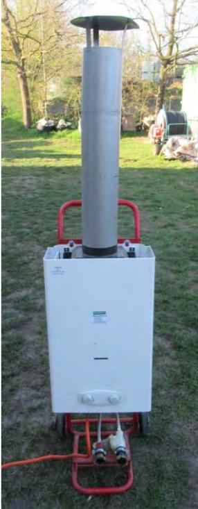
Transportabler Propan-Durchlauferhitzer auf Karren zum Erwärmen des Rührwassers. 14 KW Leistung.
